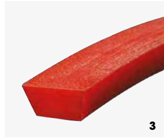
3 Correa trapezoidal mecanizada para reducir su grosor y mejorar su flexibilidad.
